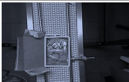
Рис. 2. Результат распознавания коробки с наггетсами в лабораторных условиях
