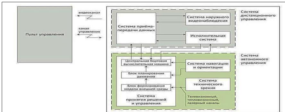
Рис. 2. Обобщенная схема системы автономного управления движением РТУ
