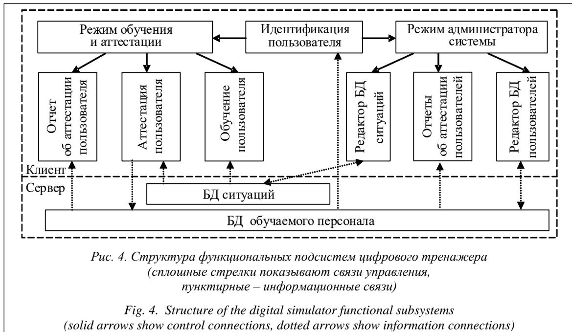
Рис. 4. Структура функциональных подсистем цифрового тренажера (сплошные стрелки показывают связи управления, пунктирные – информационные связи)
