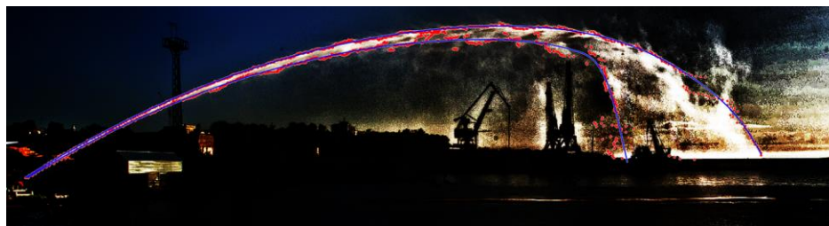
Рис. 4. Совмещенное изображение струи и ее границ, построенных на основе распознавания
