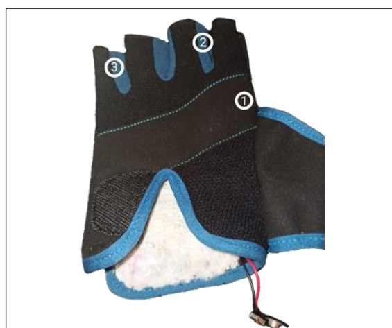
Рис. 1. Перчатка управления и расположение встроенных кнопок
